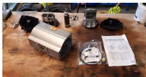
2022-10 Remise à neuf d'un actionneur pneumatique de régulation sur l'UTEP de Fabrègues .
