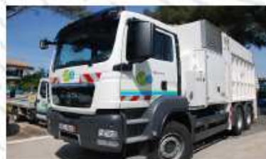
Le camion aspirateur permet de réduire les emprises de chantier, limite les nuisances pour les riverains et améliore l'ergonomie et la sécurité des agents.
